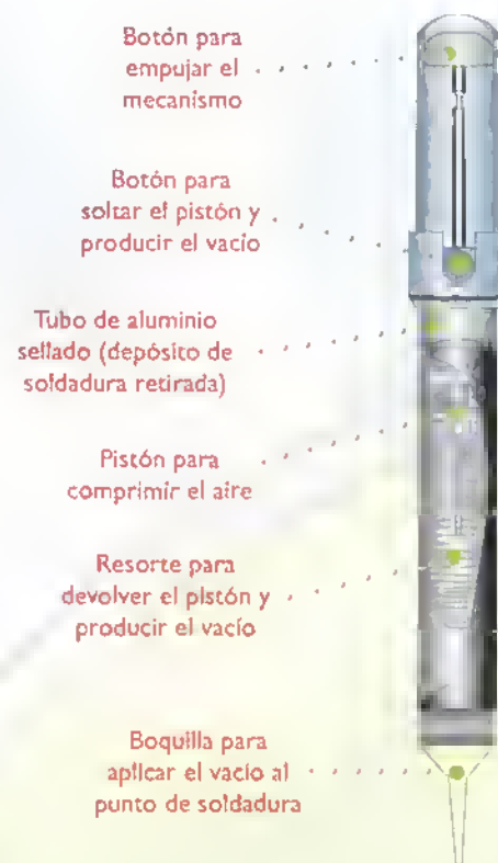
Figura 12.18. Estructura interno de un desoldador mecánico
